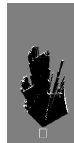
Figura 2 – Grid de ocupação, ao longo do tempo, de 800 metros quadrados. O retângulo branco indica o veículo.
