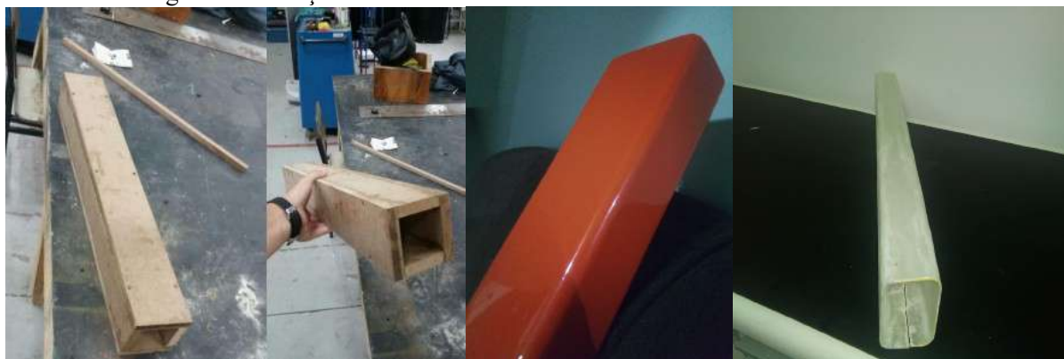
Figura 1 – Da esquerda para a direita. Fotografias do molde de madeira (dimensões: 88x88x620 mm). Fotografia do molde após acabamento superficial. Viga fabricada usando fibras de vidro e resina epóxi.
