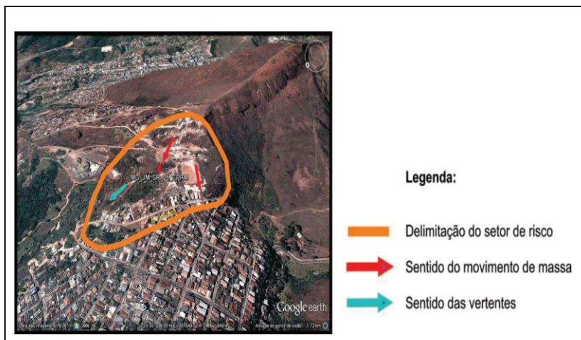
Figura 1 – Área de risco geotécnico no Parque Municipal do Areão em João Monlevade.
